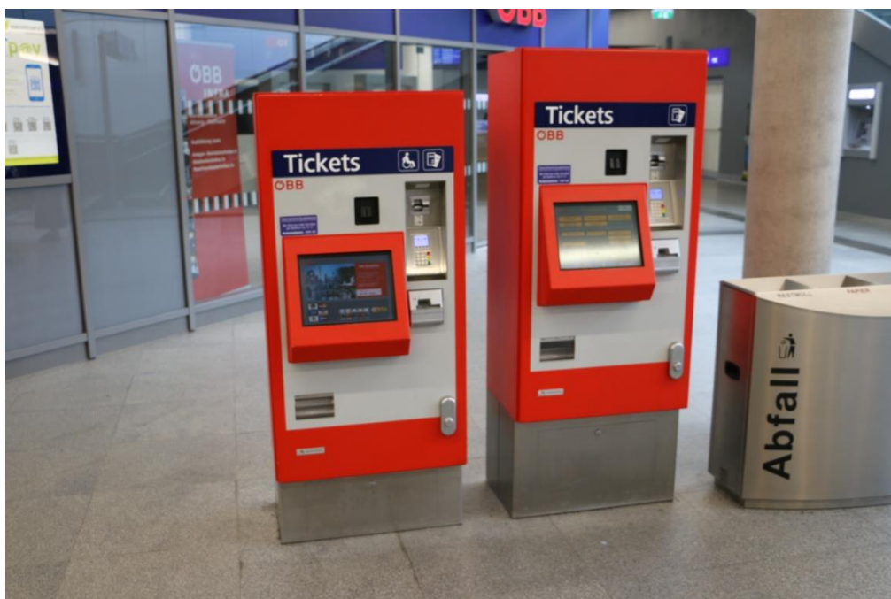
Ryc. 5.51. Pomimo umieszczenia ekranów na różnej wysokości, osoby na wózkach nie mogą podejść czołowo do biletomatu. Automaty biletowe na stacji Attnang-Puchheim. (autor: A. Zajac)
