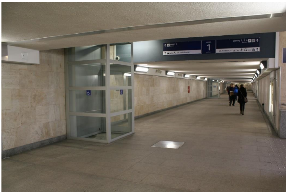
Ryc. 5.4. Tunel peronowy na dworcu Katowice z dobrze zaprojektowanym oświetleniem górnym; źle usytuowane podnożniki w strefie ciągu pieszego (autor: D. Załuski)
