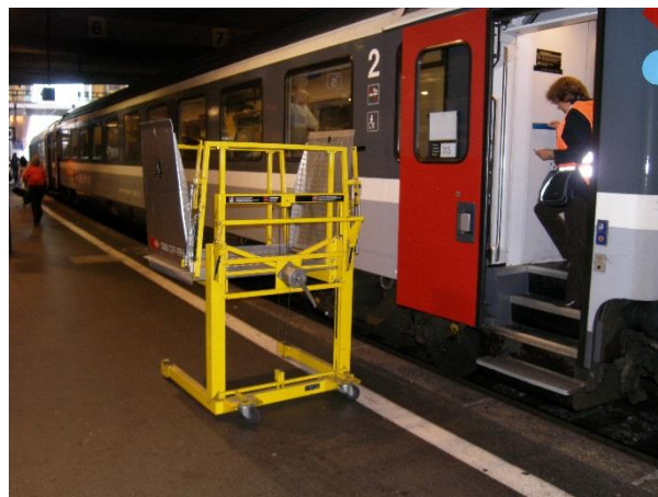
Ryc. 5.91–5.92. Przystawna platforma umożliwiająca wsiadanie osobom poruszającym się na wózkach do wagonu (autor: P. Wróblewski)
