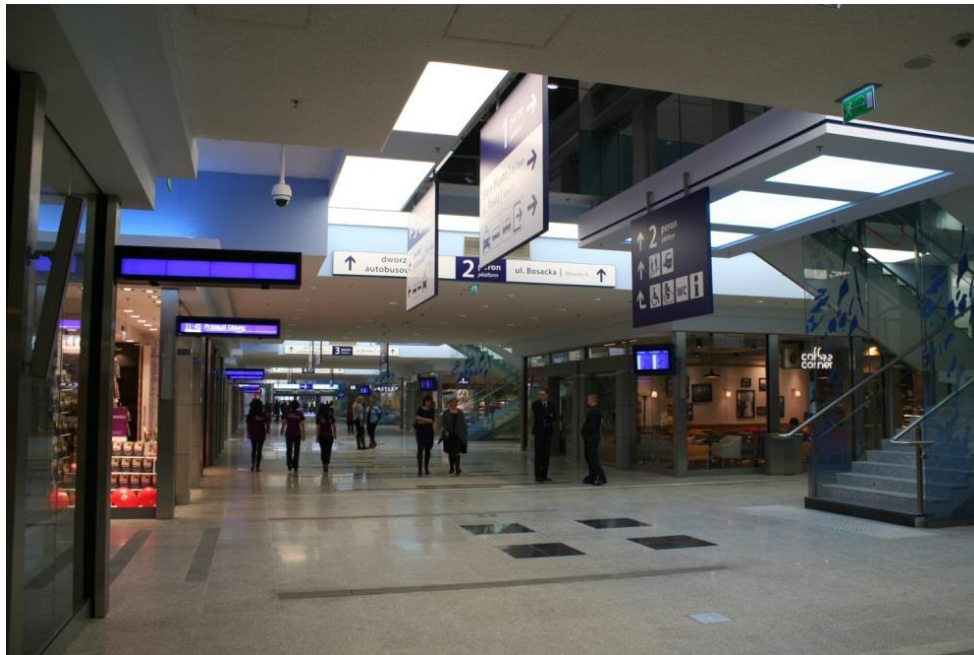
Ryc. 5.19. Przejście podziemne na dworcu Kraków Główny z oświetleniem imitującym oświetlenie dzienne (autor: D. Załuski)
