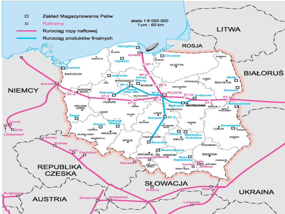
Rys. 11.3. Krajowa sieć rurociągów ropy naftowej oraz produktów finalnych.
