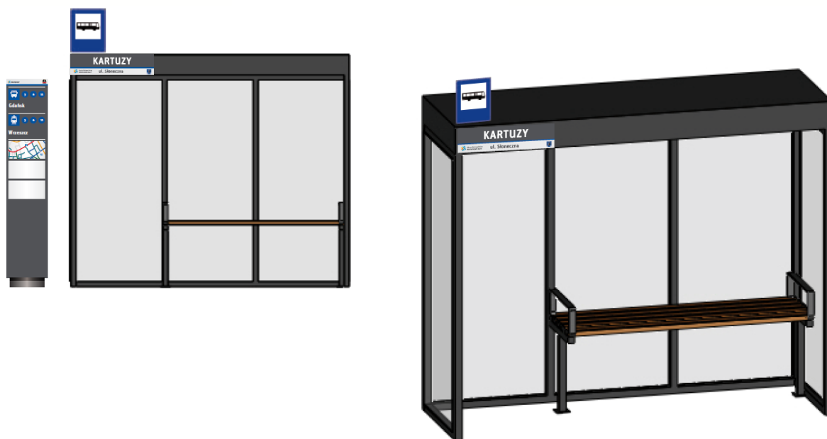
Rys. Wąska wiata przystankowa przeznaczona do stosowania w lokalizacjach o małej szerokości chodnika.
